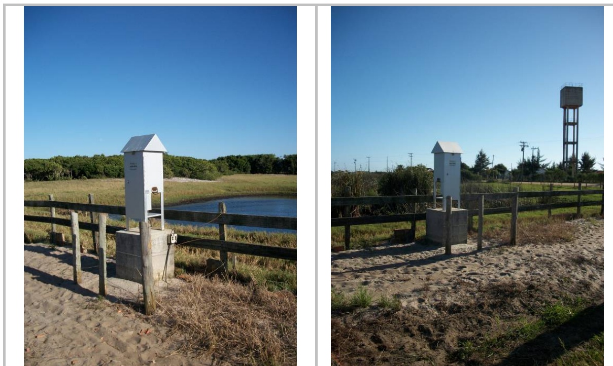
FOTO 6.3.2.1-1 e 6.3.2.1-2: Amostrador de Partículas Totais em Suspensão (HI-VOL) instalado no distrito de Barra do Açu
